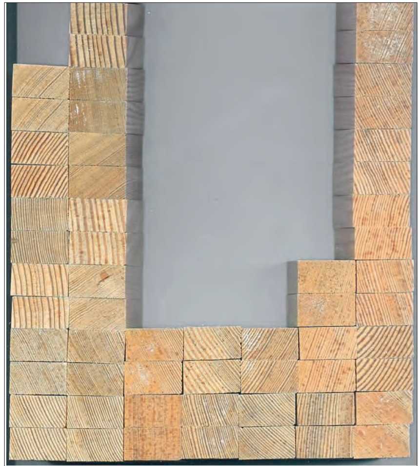
Abbildung 4 Visuelle Ansprache (Sortierung) der untersuchten Prüfkörper (Holzabbau durch den Braunfäulepilz C. puteana ) nach den ermittelten Dauerhaftigkeitsklassen (DHK) und Aceton-/Wasser-Extraktstoffgehalt für die Proben der Dauerhaftigkeitsklassen 1 und 4 (v.l.n.r.): DHK 4, 3, 2-3, 2, 1-3, 1-2 und 1. Der DHK 4 entspricht ein Aceton-/Wasser-Extraktionsgehalt von 1,33 %, der DHK 1 ein Gehalt von 2,13 % ([%] bezogen auf atro Holz).
